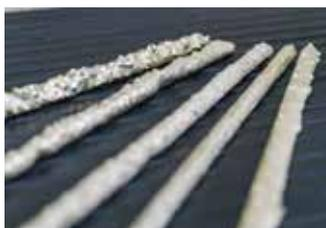
Hastes com fragmentos de metal duro Hard Braze é uma liga composta de uma matriz de Cu-Ni-Zn e a adição de Carboneto de Tungstênio de diferentes granulometrias desenvolvida para aplicações que exigem resistência à abrasão e alta ação de corte.
