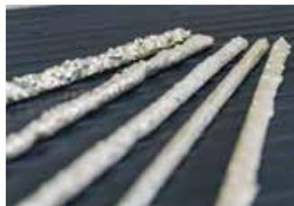
Aleación compuesta por una matriz de Cu-Ni-Zn y el agregado de carburo de tungsteno de diferente granulometría desarrollado para las aplicaciones que exigen resistencia a la abrasión, impacto y desgaste.
